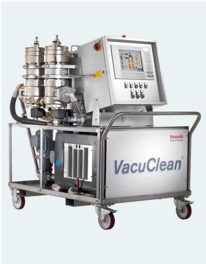
In der Praxis häufig unvermeidbar: Durch Kondensation, chemische Prozesse oder Eintritt von aussen sammelt sich im Betrieb ungebundenes Wasser im Hydrauliköl. Dies führt zur Alterung und macht einen Austausch nötig, was zusätzliche Kosten erzeugt und kostbare Ressourcen verschwendet.
